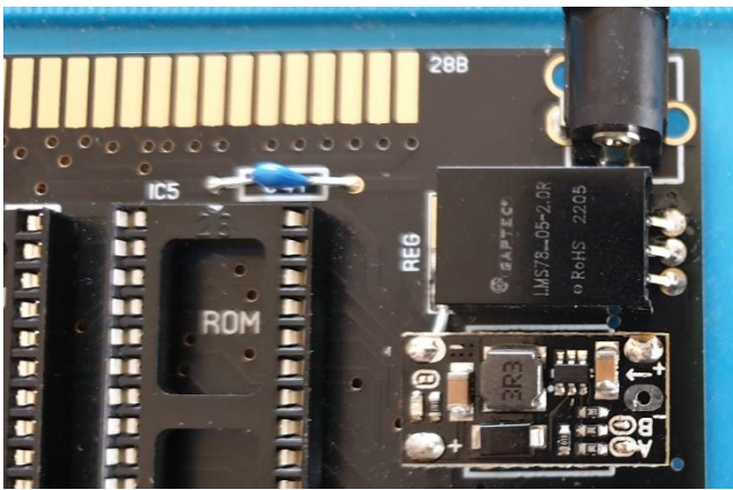
Schaltspannungregler und Mini Step-Up Modul auf einem Issue 3B Board.
